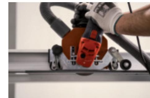
E' consigliato anche il taglio delle lastre tramite sega a secco oppure ad acqua con disco diamantato.
