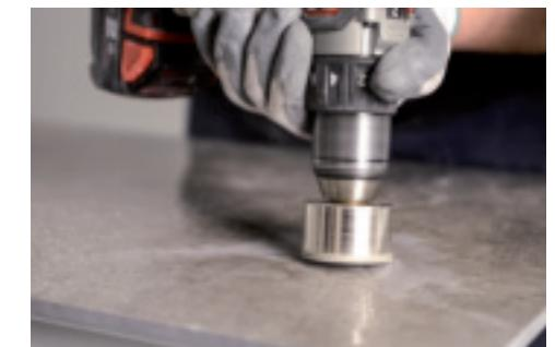
Per realizzare fori circolari sulle lastre si raccomanda di utilizzare una fresa diamantata con il diametro desiderato e di bagnare costantemente la superficie.
