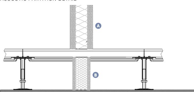
**DETTAGLIO ATTACCO A MURO + ISOLANTE SOTTOPAVIMENTO**
