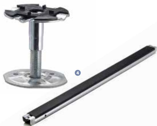
**F Bases:** elle est constituée d'un disque en tôle d'acier découpé et nervuré par estampage, auquel est soudé une barre filetée. Dans le disque de base sont réalisés des trous pour faciliter la fixation de la colonnette au support réalisé au moyen de colle ou de chevilles spécifiques. Toutes les parties qui composent la base sont zinguées. Mirage utilise trois types de bases différentes, en fonction des exigences du client qui peuvent varier selon le diamètre, l'épaisseur et la forme.
