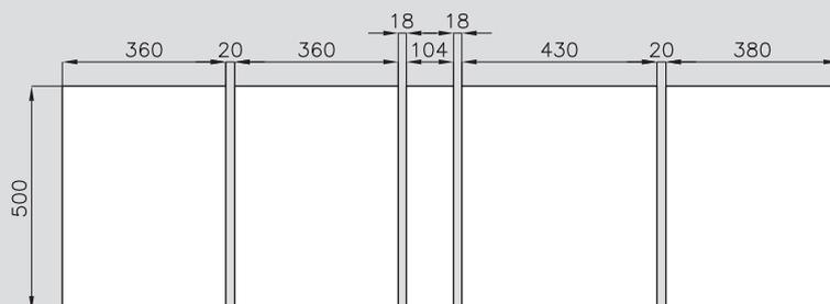
Fori incasso: per la corretta installazione in continuo va mantenuta una distanza di 20 mm tra i gli incassi dei prodotti (con eccezione di una distanza di 18 mm tra incasso cappa e altro prodotto). Per assicurare l'allineamento verticale dei prodotti si consiglia una profondità dell'incasso unica di 500 mm, indipendentemente dalla misura richiamata nel libretto (480, 490, 500 mm a seconda dei modelli).
