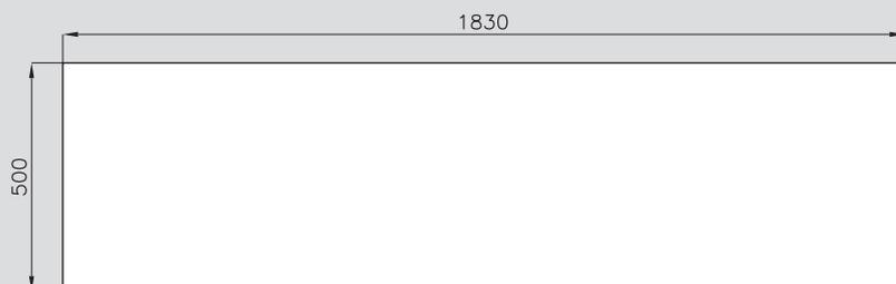
Fori incasso: con l'utilizzo dei distanziatori è possibile installare i prodotti in un unico foro da incasso, di misura: in profondità: 500 mm in profondità; in lunghezza: pari alla somma delle dimensioni dei prodotti e dei distanziatori, diminuita di 20 mm. (nell'esempio sopra riportato, da SX:  $(380 + 30 + 380 + 30 + 120 + 30 + 450 + 30 + 400) \text{ mm} - 20 \text{ mm} = 1830 \text{ mm}$ )
